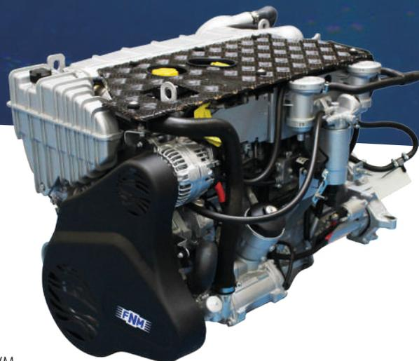
Il motore 42HPEP di FNM® è stato sviluppato su base motore VM.
