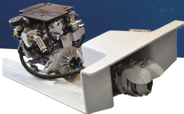
Il motore 4 cilindri 13HPE JD di FNM® è basato sul propulsore 1,3 Multijet II, un riferimento nel settore automobilistico dei piccoli motori diesel. Questo motore marino entro bordo utilizza un sistema di iniezione common-rail controllato elettronicamente da una ECU (Electronic Control Unit), espressamente configurata per questa unità.
